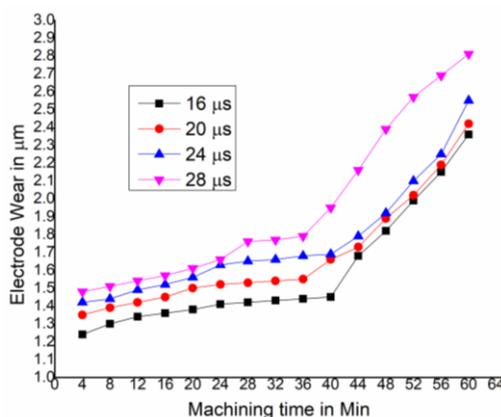
**Fig 4 : EW v/s Machining Time for titanium material**
