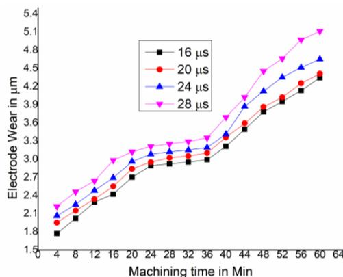
**Fig 5 : EW v/s Machining Time for stavax material**
