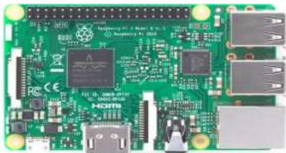
Fig 1. Raspberry Pi module
