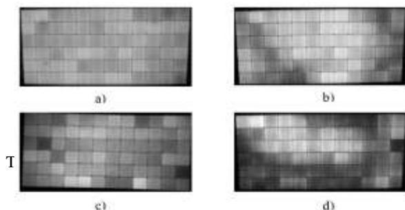
Fig. 6EL Images a) 0 hrs Module, b) 96 hrs Module, c) 192 hrs Module, d) 288 hrs Module
