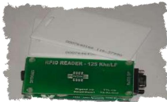
**FIG. 3 RFID READER-125Khz/LF**
